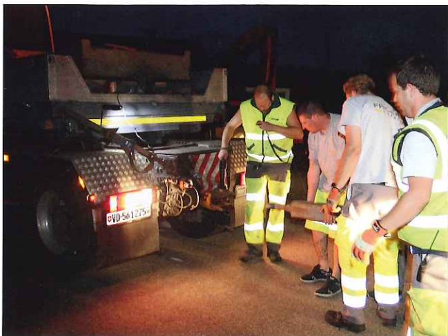
Millimeterarbeit: Es wird immer wieder eng – bei der Sommerhalde beispielsweise. Mehrmals werden Schub- und Zugmaschinen umgehängt.
