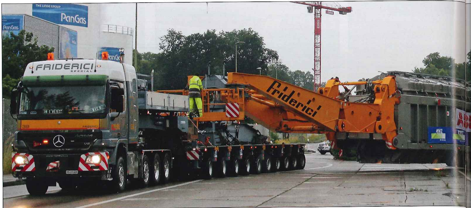
Trafo-Schwertransport: Start im Basler Auhafen. Die Zugmaschine ist ein Actros MP 2. Insgesamt waren drei davon im Einsatz.
