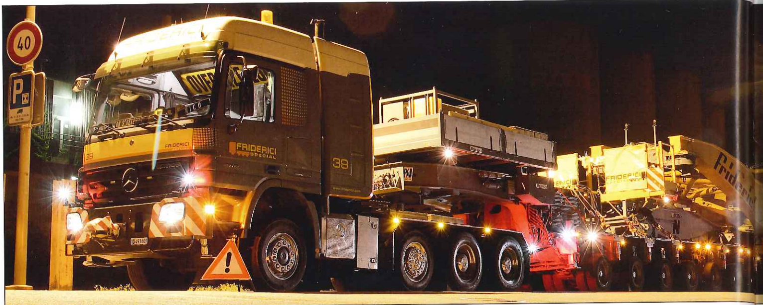
Kurz vor der Abfahrt: Dieses gewaltige Gespann ist über 81 Meter lang und fast viereinhalb Meter breit. Eine Herausforderung für den Transporteur.
