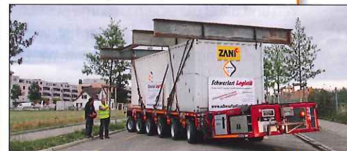
Brückenhub: Das Modul kann alle Räder rechtwinklig zur eigentlichen Fahrtrichtung einstellen, um dann unter die Brücke zu fahren (oben). Danach rollt es ohne Zugmaschine mit dem Brückenelement huckepack zum Deinstallationsplatz, wo es dann doch Kranen braucht, um es abzuladen.
