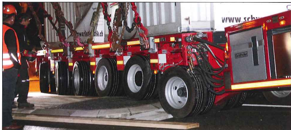
Brückenhub: Das Modul kann alle Räder rechtwinklig zur eigentlichen Fahrtrichtung einstellen, um dann unter die Brücke zu fahren (oben). Danach rollt es ohne Zugmaschine mit dem Brückenelement huckepack zum Deinstallationsplatz, wo es dann doch Kranen braucht, um es abzuladen.
